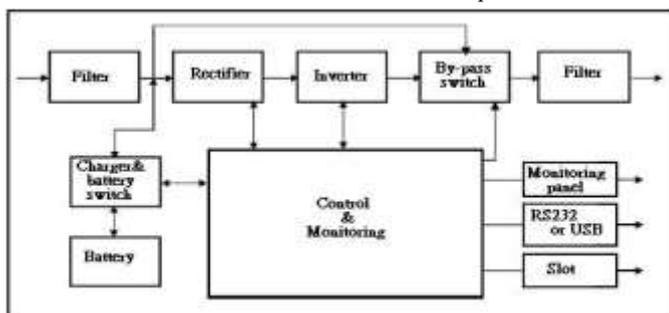
Fig.1. Schema a blocchi
